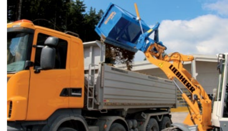
De best mogelijke storthoogte door het hoogkiepeffect
