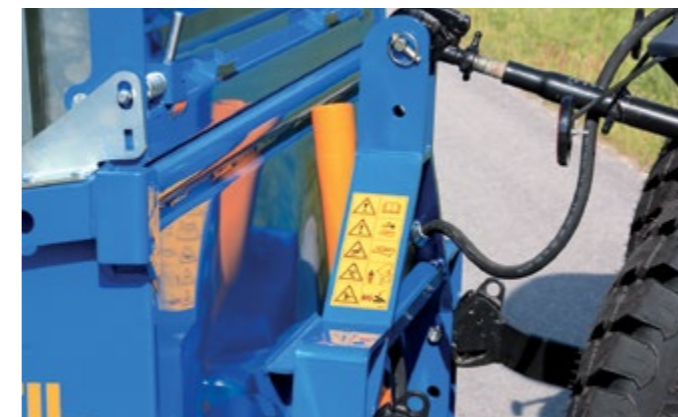
Staande, goed beschermde cilinder met maximaal hefvermogen
