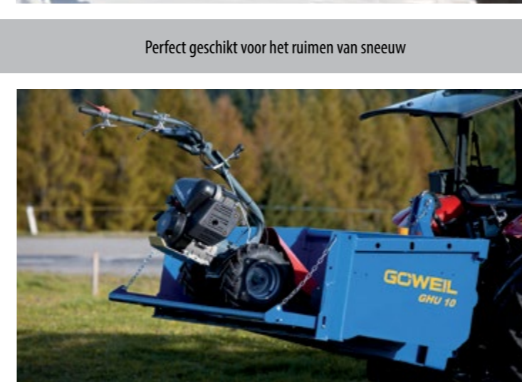
De pendelklep kan optimaal worden gebruikt als bakverlenging
