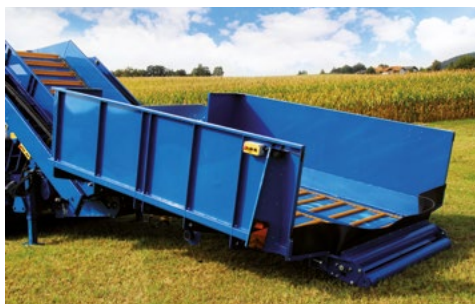
4. Wanden van de opvoerband en van de stortbak opklappen
